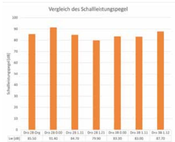
Resultatbeispiel zu den Varianten für Drohnen-Propeller anhand der unbewerteten Schalleistung.
