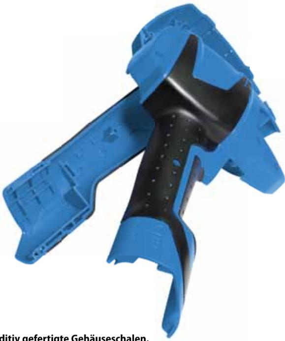
**Additiv gefertigte Gehäuseschalen.**
