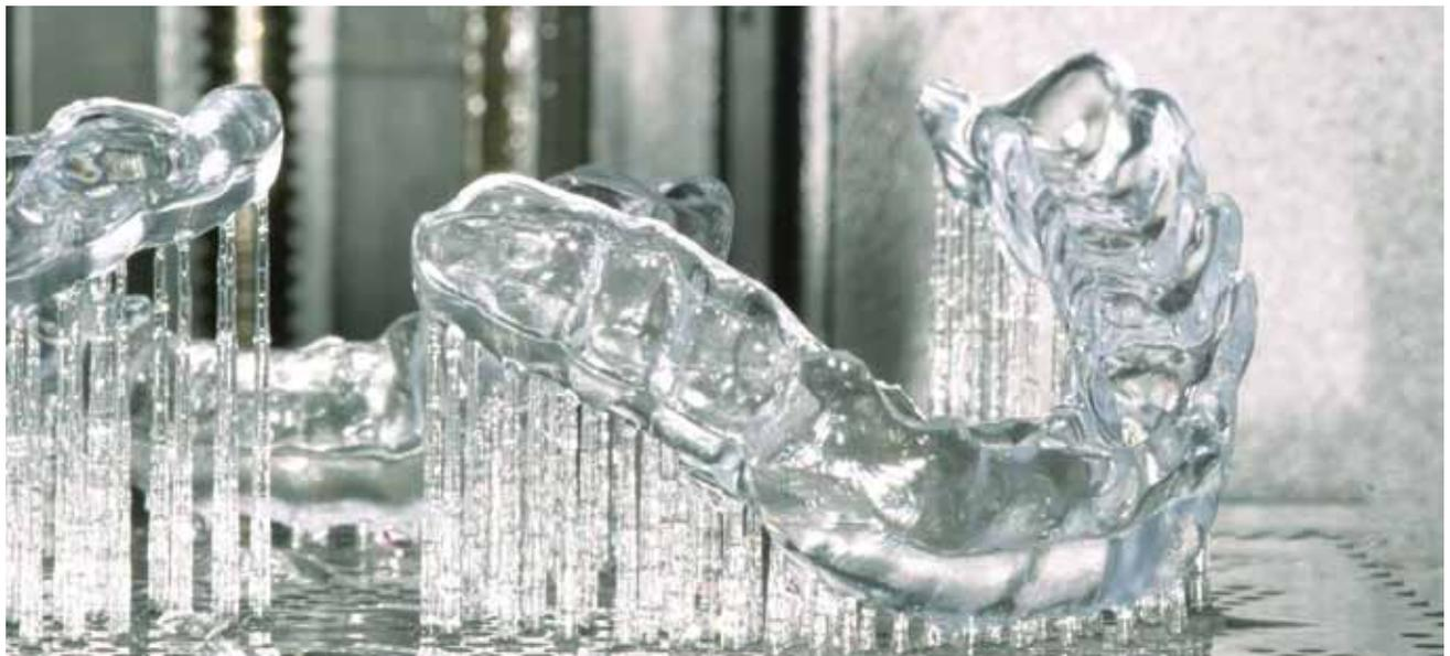
**Medizinprodukte lassen sich dank additiver Fertigung individuell an den Körper des Patienten anpassen und trotzdem kostengünstig herstellen. Im Bild eine 3D-gedruckte Zahnschiene. (Bild: Ulbricht Dental-Technik)**
