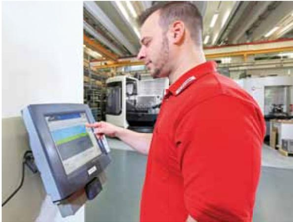
**Ergänzend zur automatischen MDE ermöglicht die BDE-Software manuelle Eingaben der Mitarbeiter, zum Beispiel für Bemeldungen von Stückzahlen, Rüst- oder Wartungsvorgängen sowie Fehlermeldungen. Hierzu stehen 15 Industrie-PCs vom Typ C15 von Noax festinstalliert an den Arbeitsstationen zur Verfügung.**
