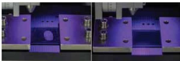
**Die Vorher-Nachher-Aufnahme unter UV-Licht zeigt, dass Verunreinigungen auf Bauteilen aus allen technischen Werkstoffen prozesssicher entfernt werden.**
