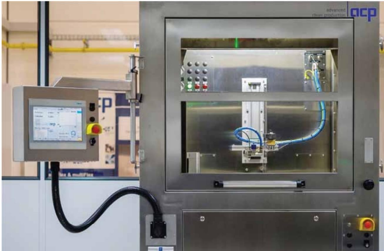
**Das zu reinigende Werkstück wird bei der komplett aus Edelstahl gefertigten Standalone-Anlage «JetStation-HP» für die automatisierte Reinigung auf der Teileaufnahme eines x-/y-Achssystem, Drehtischs oder einer Kombination aus beidem in der Prozesskammer platziert.**
