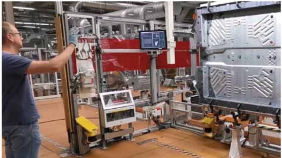
**Automobilproduktion bei Volkswagen in Zwickau: Berührungsfreie Gestensteuerung von Schwerlastrobotern im Anwendungstest.** (Bilder: Fraunhofer IWU)
