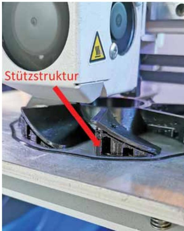
Einer der Propeller im 3D-Printer, noch mit den notwendigen Stützstrukturen versehen. (Bilder: OST)
