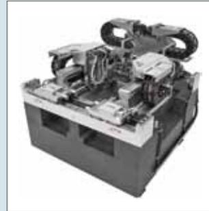
Freiheitsgraden X, Y und Z, wobei insgesamt acht Achsen gesteuert werden können. Laut Angaben des Anbieters erfüllt die Plattform die anspruchsvollsten Anforderungen von hochentwickelten Die-Bonding-Prozessen (Flip-Chip, Fan-Out, 3D-Stacked-Packages,  $\mu$ -LED-Bonding), Dosieranwendungen und mehr. Die Architekturen konventioneller Bewegungssysteme sind durch ihre Konstruktion entweder auf hohe Positioniergenauigkeit oder hohen
